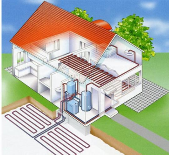
**Figura 63.** Schema di un impianto geotermico a bassa entalpia con le relative sonde geotermiche disposte secondo un andamento orizzontale del terreno.
